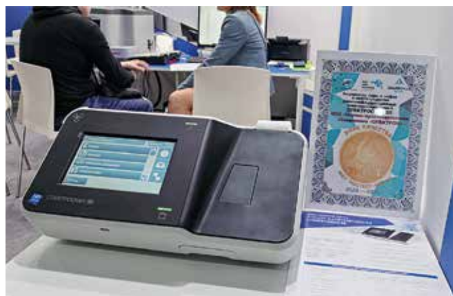
Анализатор серы в нефти и нефтепродуктах «СПЕКТРОКАН SE»
